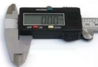
ภาพที่ 2.18 แสดงแถบหน้าจอบนเวอร์เนียร์คาลิปเปอร์แบบดิจิตอล
