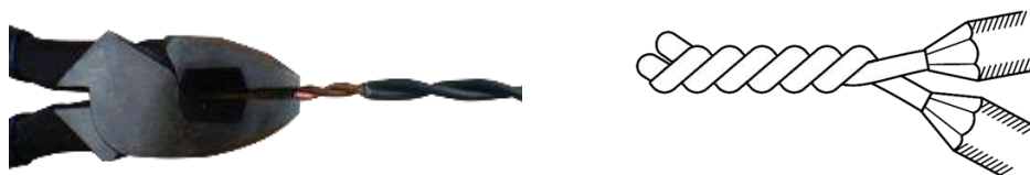
ภาพที่ 1.36 บิดสายไฟเป็นเกลียว
