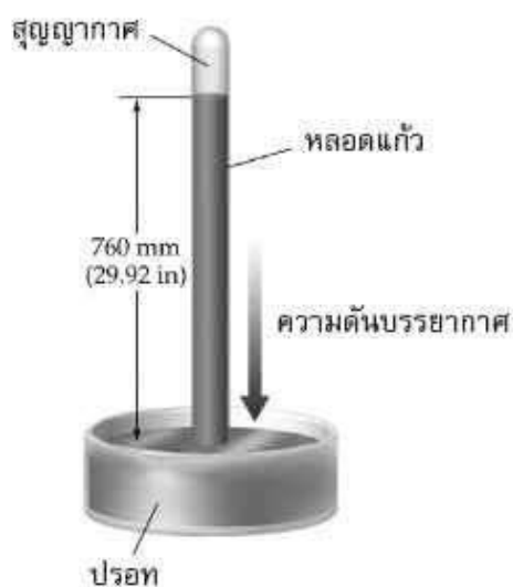
ภาพที่ 2.2 บารอมิเตอร์แบบเบื้องต้น
